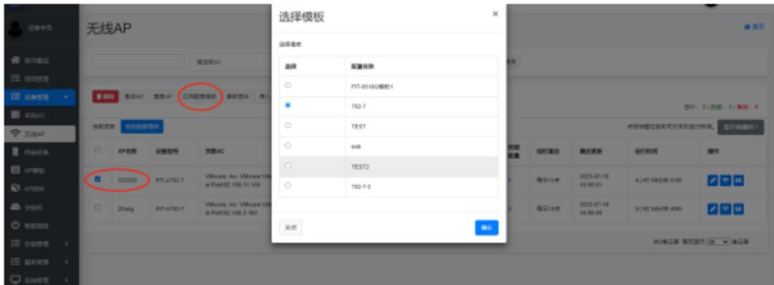
3. AP 固件升级：打开“设备管理” -- “AP 固件” 页面，上传对应型号的 AP 固件，上传完成后，在“无线 AP” 管理页面，选择同一型号的 AP，点击“更新固件” 按钮，选择需要更新的固件，点击确认即可升级。
