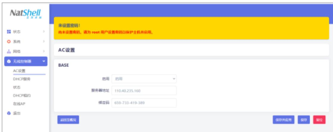
该绑定码填写后，本地 AC 上报给云平台时，会自动将该 AC 设备归属到该绑定码对应的项目中。
